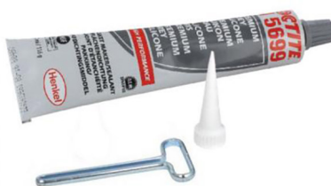
SI 5699 joint en silicone gris Contenu: 80 ml, Couleur: gris, Type de produit chimique: Silicone Oxime, Ecart maximal d'étanchéité: 1,0mm, Plage de température: -60 °C à +200 °C
