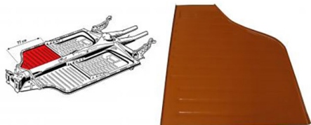
Quart de plancher de châssis avant droit Ghia, Type 181
