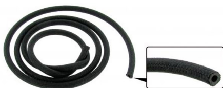
Durite/flexible extérieur textile pour raccords de dépression/vacuum d'allumeur/distributeur, au mètre Diamètre intérieur 3,5mm, Diamètre extérieur 7,5mm, Pression de travail: 7 bar, Pression de rupture: 30 bar, Remarques Approuvé pour l'essence fossile plombée et sans plomb E5, E10, E15, E85 et le diesel
