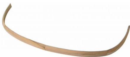
Arche de montage en bois pour capote de cabriolet (en 2 pièces) Ghia cabriolet jusque 1967 (châssis 147 610 909)
