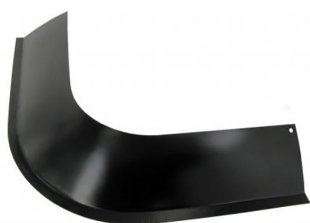
Tôle de réparation de l'angle du toit arrière gauche ou droit (la pièce) Combi jusque 7.1967
