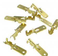
Cosses à sertir plates mâles sans isolation avec barbe, lot de 10 pièces Taille du connecteur: 6,3mm, Épaisseur du matériau: 0,8mm, Épaisseur du fil: 1,5-2,5mm 2
