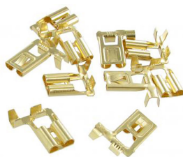
Cosses à sertir plates femelles coudées/angle 90° sans isolation avec barbe, lot de 10 pièces Taille du connecteur: 7,8mm, Épaisseur du matériau: 0,8mm, Épaisseur du fil: 2,5mm 2
