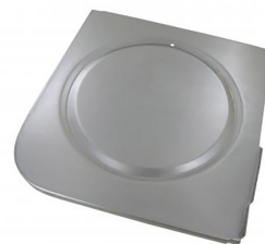
Tôle de châssis côté arrière gauche Combi jusque 7.1967 uniquement pickup
