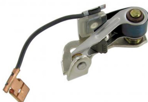
Rupteur d'allumage/vis platinées Moteurs Cox 1200 de 1974 (D 1 307 619) et après, 1300 de 8.1968 et après, 1500 de 1967 (L 0 019 430) et après, 1500 de 1967 (H 0 879 927 + 5 077 366) et après, 1600, Moteurs type 3 1500 jusque 7.1964, 1600 code U, 1600 de 1967 (T 0 463 430) et après, Moteurs T4 WBX, 009
