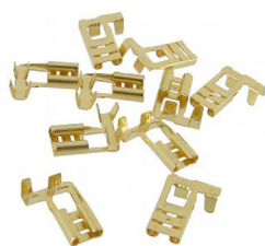
Cosses à sertir plates femelles coudées/angle 90° sans isolation sans barbe, lot de 10 pièces Taille du connecteur: 6,3mm, Épaisseur du matériau: 0,8mm, Épaisseur du fil: 1,0-2,5mm 2
