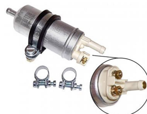
Pompe à essence électrique, qualité A 12 volts, 0,27 à 0,38 bar, 90 litres/heure
