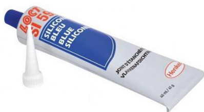
SI 5926 composé d'étanchéité en silicone bleu Contenu: 40 ml, Couleur: bleu, Type de produit chimique: Acétoxy Silicone, Espace d'étanchéité maximum: 1.0mm, Plage de température: -54 °C à +150 °C
