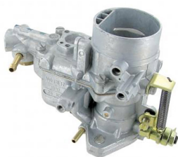
Carburateur Weber 34 ICT (la pièce) Gicleur d'alimentation essence: 135, Gicleur air: 160, Gicleur de ralenti: 55, Tube d'émulsion: F78
