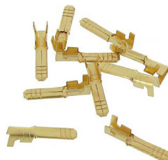
Cosses à sertir plates mâles sans isolation sans barbe, lot de 10 pièces Taille du connecteur: 2,8mm, Épaisseur du matériau: 0,8mm, Épaisseur du fil: 0,5-1,5mm 2
