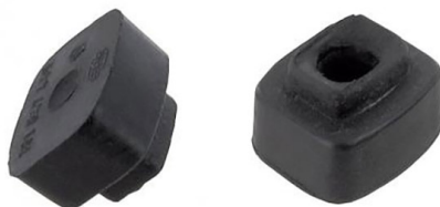
Caoutchoucs de fixation de cadre de fenêtre avant, ou pour ambulance (la paire) cadre de fenêtre avant Type 181, brancard d'ambulance Combi de 8.1967 jusque 7.1974, Combi T3, siège pliant Combi de 8.1970 et après
