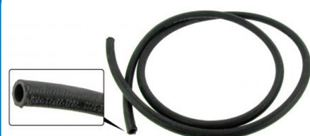
Ontluchtings slang met textiel buitenzijde per meter Binnendiameter: 12mm, Buitendiameter: 17mm, Working pressure: 7 bar, Bursting pressure: 30 bar
