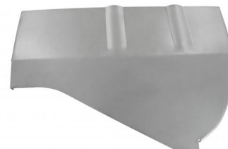
Reparatieplaat achterste wielkast links voorzijde Bus t/m 7.1979
