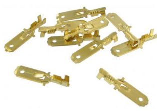
Ongeïsoleerde mannelijke vlakstekkers met weerhaak (10 stuks) Spade connectormaat: 6.3mm, Materiaal dikte: 0.8mm, Draad dikte: 0.5 - 1.0mm 2
