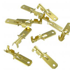
Ongeïsoleerde mannelijke vlakstekkers met weerhaak (10 stuks) Spade connectormaat: 6.3mm, Materiaal dikte: 0.8mm, Draad dikte: 1.5 - 2.5mm 2
