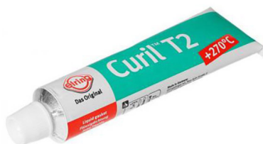
Curil T2 vloeibare pakking Inhoud: 70 ml, Kleur: groen, Maximale afdichtingsruimte: 0.2mm, Treksterkte: 0.034 N// mm 2 , Temperatuurbereik: -55 °C naar +250 °C (voor 24 uur tot +270 °C)
