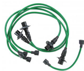
Standaard bougiekabelset groen type-1 motoren t/m 1988 (11-J-012 804), CT/CZ motoren
