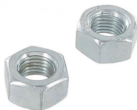
Veiligheidsgordelsteun montage moeren (per paar) Schroefdraadmaat: 7/16 UNF, Dikte: 9.47mm, Sleutelmaat: 11/16
