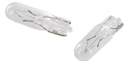
Controlelampjes, schakelaars en dashboard instrumenten verlichting lampjes 12V (per paar) type: T5, Voet: W2, Kleur: helder, Spanning: 12V, Vermogen: 1.2 Watt
