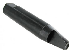
Wieldop klinknagel montage gereedschap Kever t/m 7.1965, Bus t/m 7.1970, type 3 t/m 7.1965, Kübel
