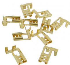
Ongeïsoleerde haakse vrouwelijke vlakstekkers zonder weerhaak (10 stuks) Spade connectormaat: 6.3mm, Materiaal dikte: 0.8mm, Draad dikte: 1.0-2.5mm 2
