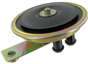
Claxon lage toon B-kwaliteit Spanning: 12V, Geluidssterkte: 110 dB
