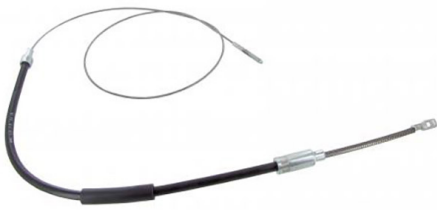
Handremkabel (per stuk) Kübel 1.1972 t/m 2.1973
