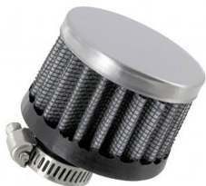
Carterontluchtfilter met een verchromde bovenzijde Bovenzijde: 50mm, Onderzijde: 57mm, Hoogte: 41mm, Aansluiting binnenmaat: 13mm
